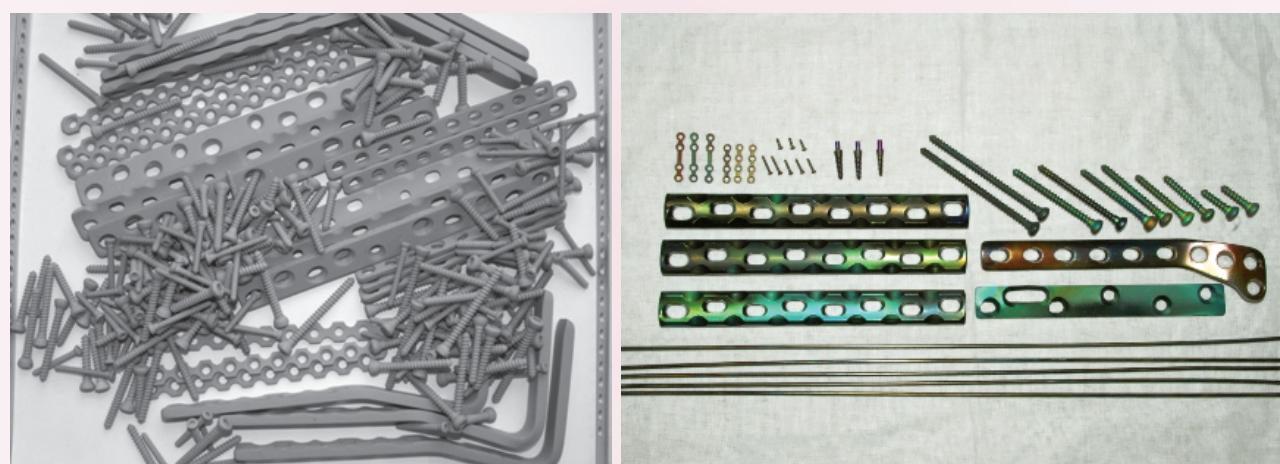
Интегрированием вакуумных методов нанесения металлических покрытий и анодного оксидирования в дуговом режиме удается получать КФ покрытия на имплантатах из нержавеющей стали.
