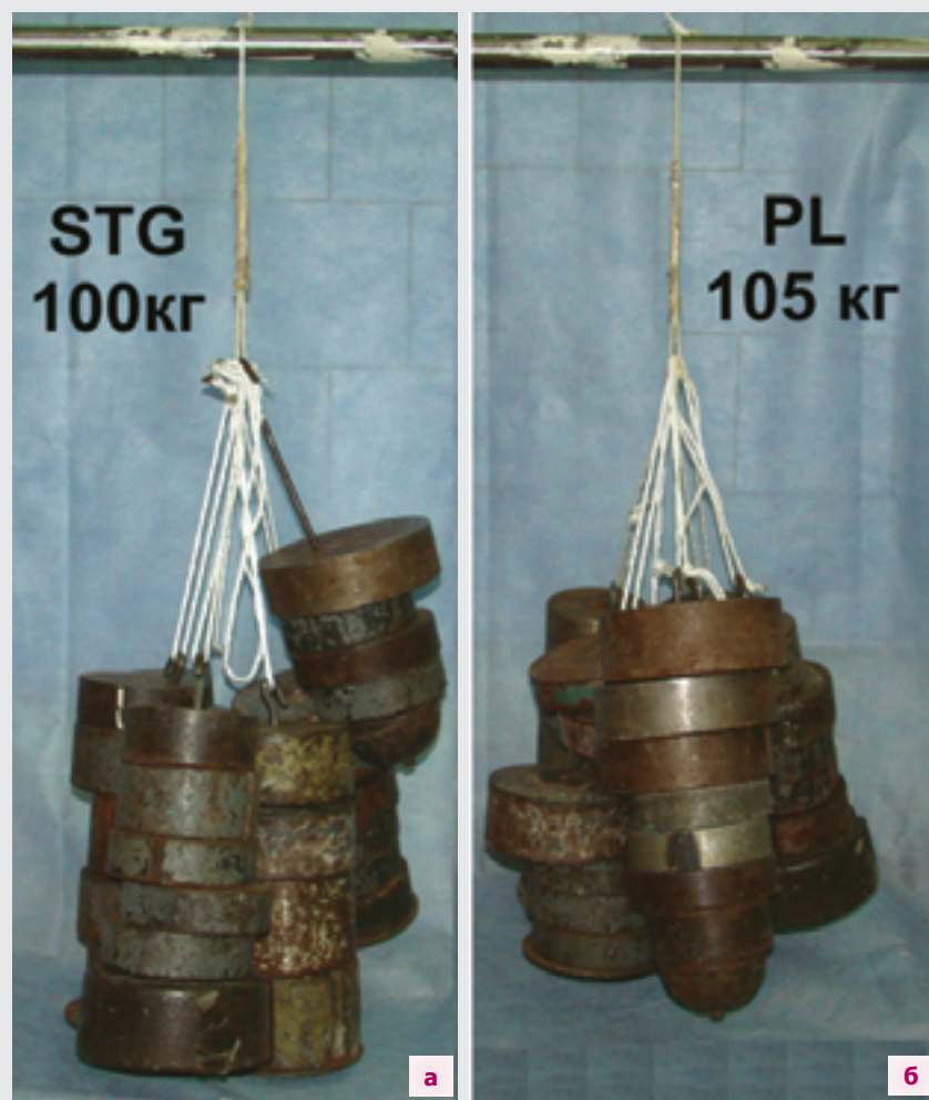
Рисунок 3 Проба на разрыв сформированных трансплантатов
